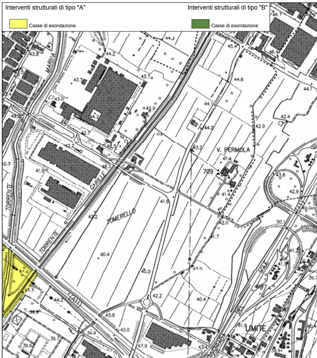
FIGURA 4. CARTA DEGLI INTERVENTI STRUTTURALI PER LA RIDUZIONE DEL RISCHIO IDRAULICO NEL BACINO DELL'ARNO
