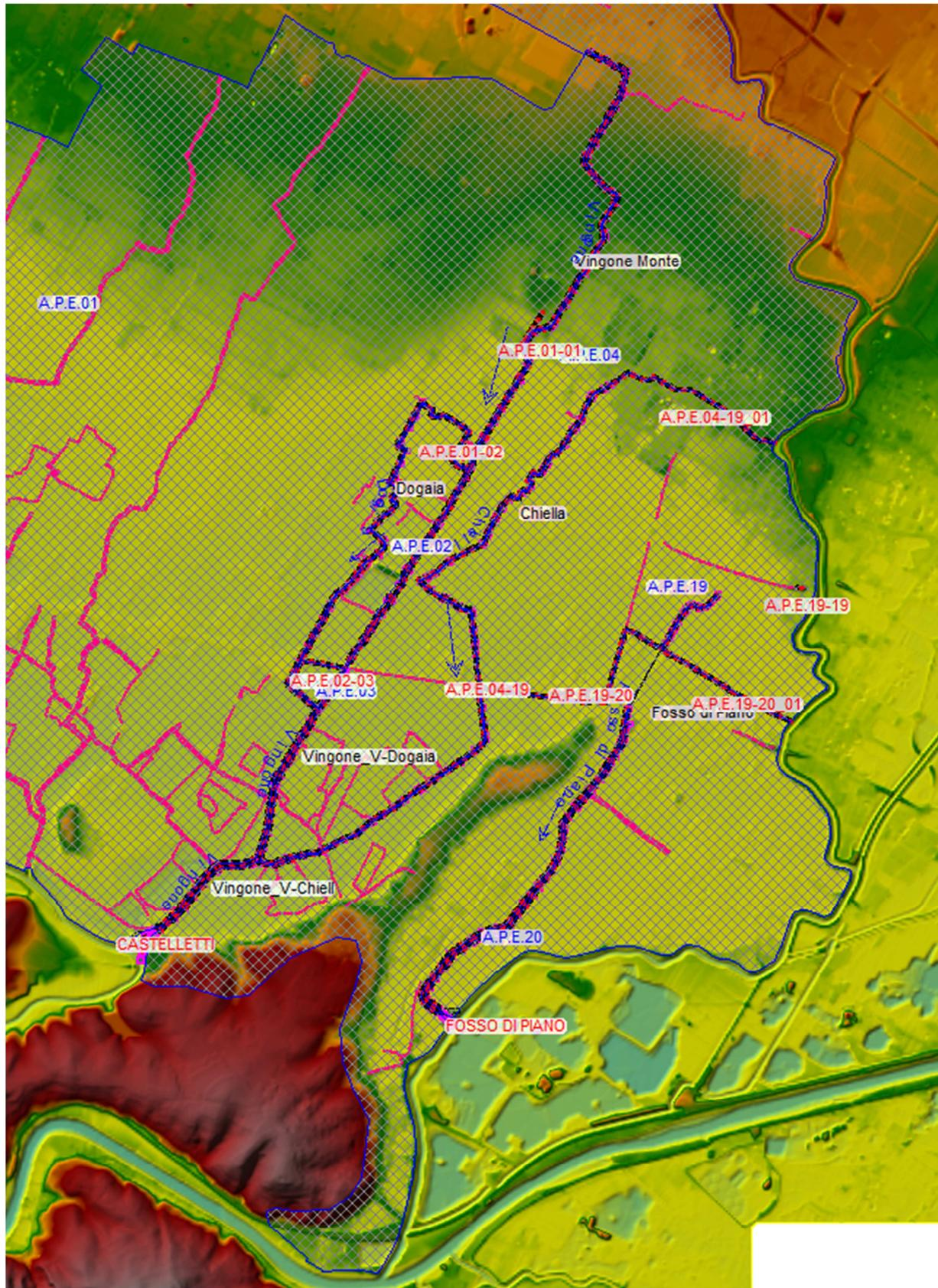
FIGURA 14. SCHEMATIZZAZIONE DEL MODELLO IDRAULICO SU BASE DTM LIDAR – GEO2
