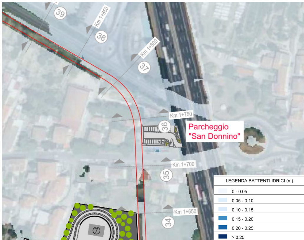
Figura 8 Battenti idrici in corrispondenza del Parcheggio S. Donnino
