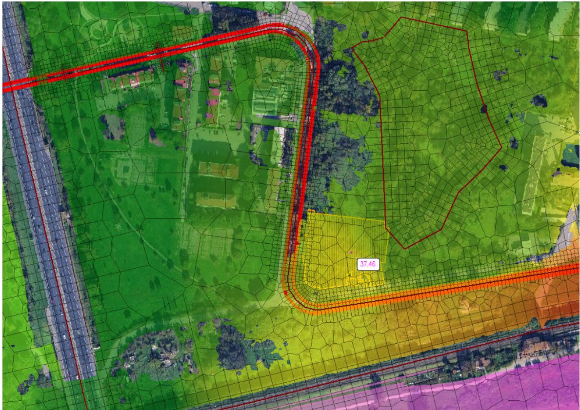
Figura 1 Risultati del modello idraulico in corrispondenza del Parcheggio e della SSE Elettrica Campania
